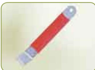
**Съёмники фиксаторов декоративной отделки**
